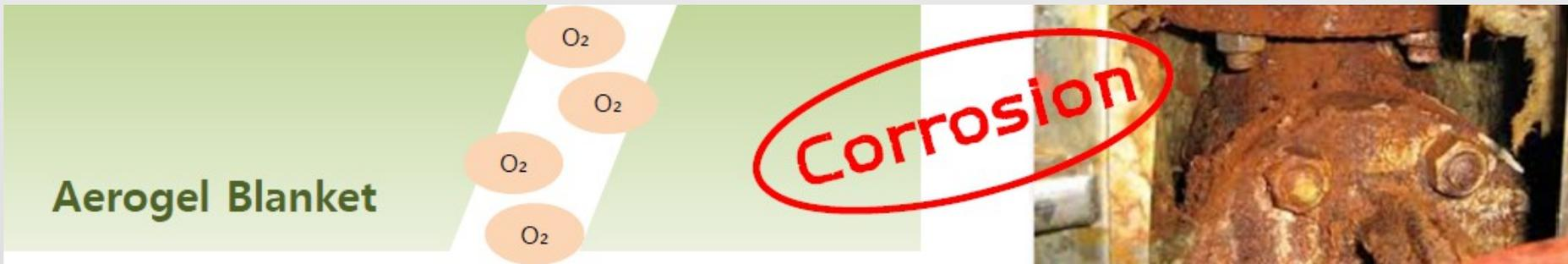
*In caso di aerogel blanket, installata su un rivestimento pre-esistente danneggiato, non risolve completamente il problema, a causa del processo di ossidazione dovuto all'O<sub>2</sub> presente tra la tubazione (ricoperta) e la superficie di aerogel*
