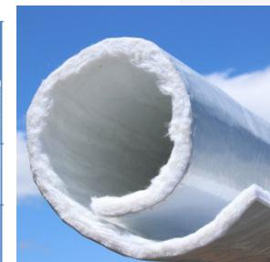
2) TEST Pannello 2: AFH11-2E spessore 16,5mm (AFH11-2E 0,5mm + fibra vetro 8mm+ fibra vetro 8mm)
