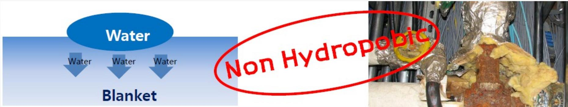
*Le blanket esistenti non sono completamente idrofobe, facilitando l'assorbimento di umidità (con la tendenza al restringimento della copertina)*
