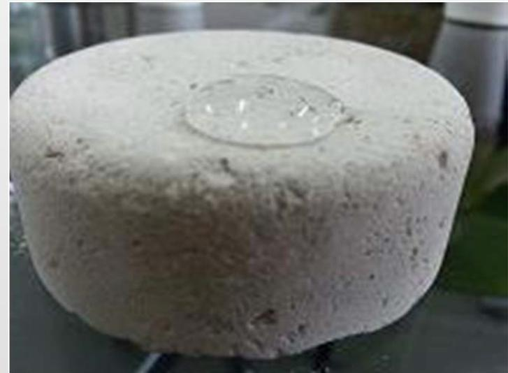
*Proprietà idrofobiche del composto aerogel - cemento*
